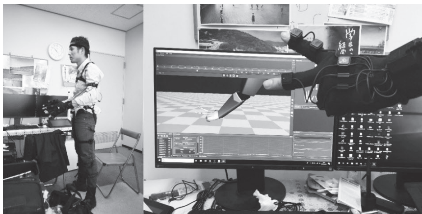
図 5. PERCEPTION NEURON を装着した (左) Axis Neuron を使ってモーションデータを取得している (右)
